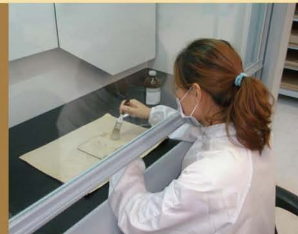
吸気式ケミカルフードを利用して汚れた空気を排出
