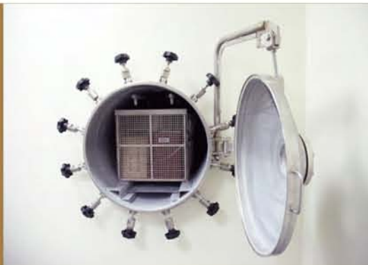
図書の大量脱酸システム処理キャビン
